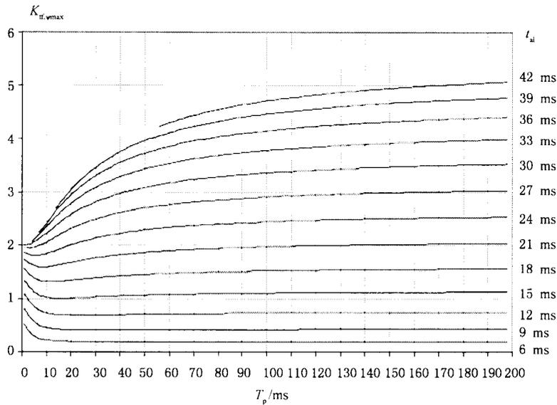
图 2E.6  $K_{tf}$  的确定(在时间范围 1 及 16.7 Hz 和  $T_s = 5.5$  s 条件下)
