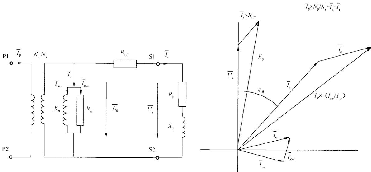
图 2G.1 电流互感器简化等效电路图
