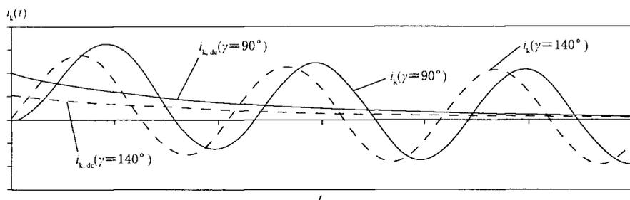
**图 2E.1 两种故障初始角的短路电流**
