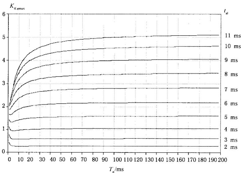
图 2E.5  $K_{if}$  的确定(在时间范围 1 及 60 Hz 和  $T_s = 1.5$  s 条件下)
