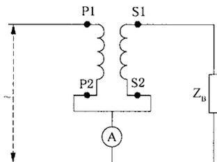
图 2D.4 1 : 1 电流互感器的基本电路
