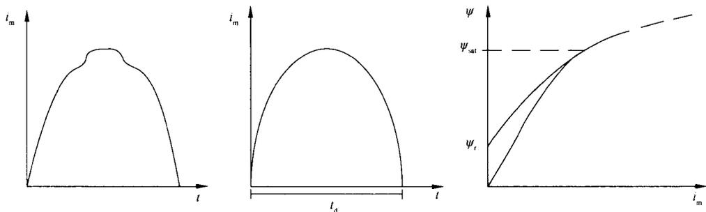
图 2E.14 电容放电法的典型记录图
