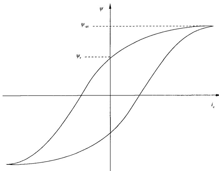
图 2E.9 磁滞回环确定剩磁系数
