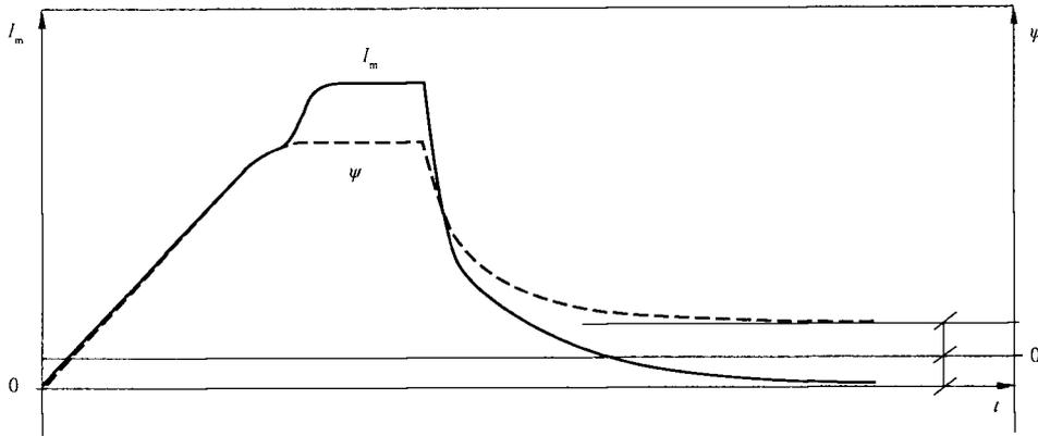
图 2E.12 磁通基线平移的记录图
