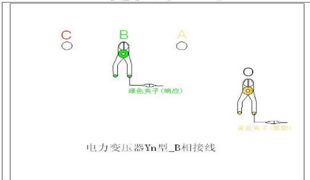
3. 夹子(输入)钳在变压器的0点上, 绿色夹子(测量)钳在变压器的C, 及代表三相Yn型C的测量。
