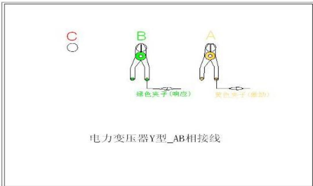
2. 色夹子(输入)钳在变压器的 B 相上，绿色夹子(测量)钳在变压器的 C
