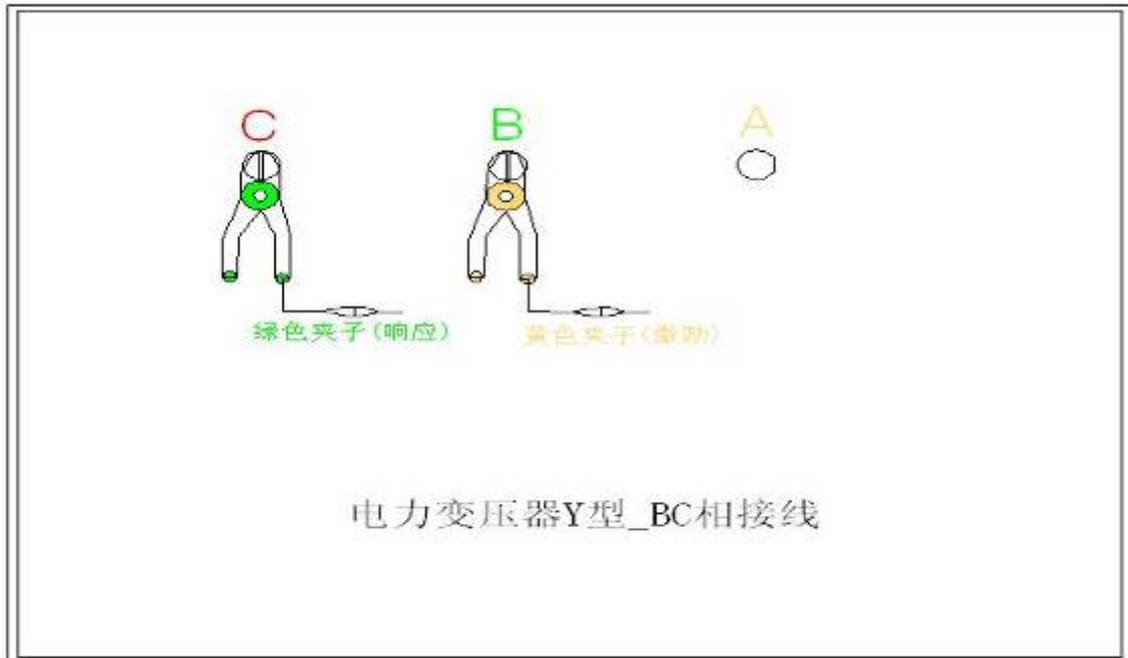
3. 黄色夹子(输入)钳在变压器的 C 相上，绿色夹子(测量)钳在变压器的 A 上，及代表三相 Y 型 CA 的测量。
